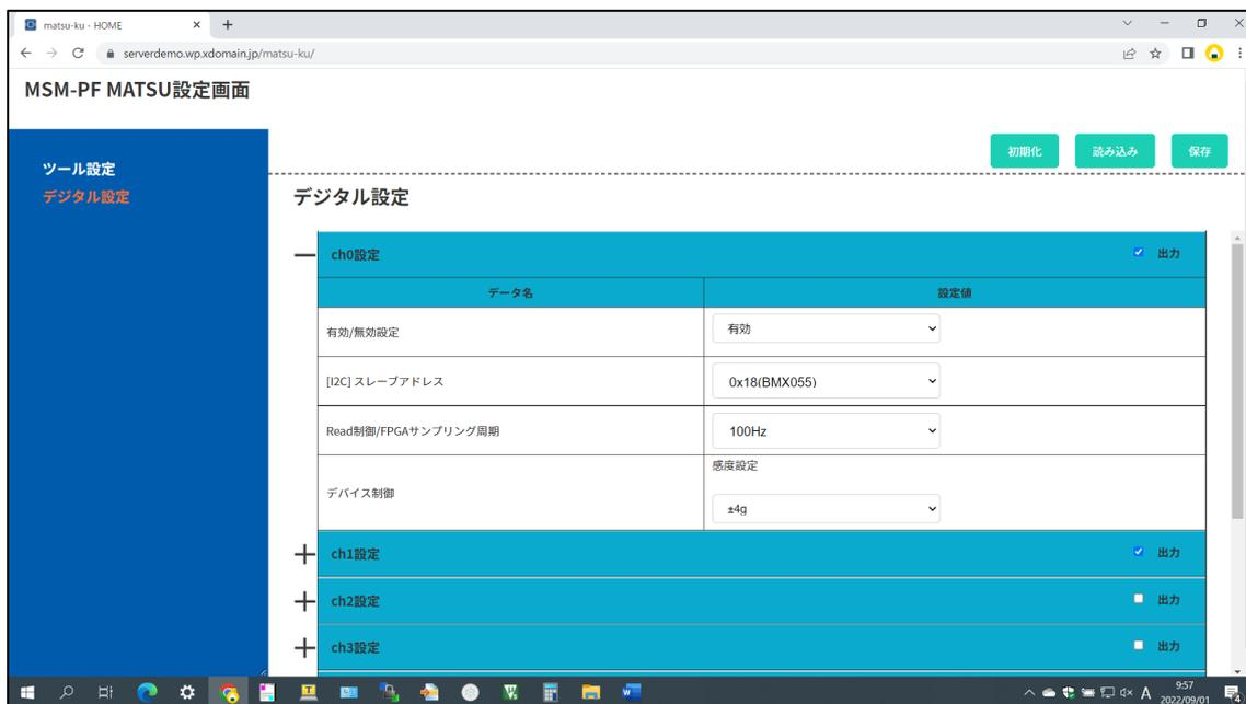
「Read 制御/FPGA サンプリング周期」は 50Hz と 100Hz が選択できます。「デバイス制御」の感度設定は ±2G、 ±4G、 ±8G、 ±16G から選択できます。
