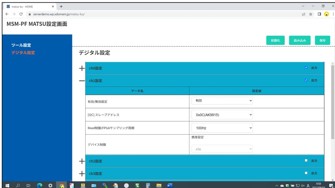
「Read 制御/FPGA サンプリング周期」は 50Hz と 100Hz が選択できます。「デバイス制御」の感度設定は固定になっています(選択できません)。
