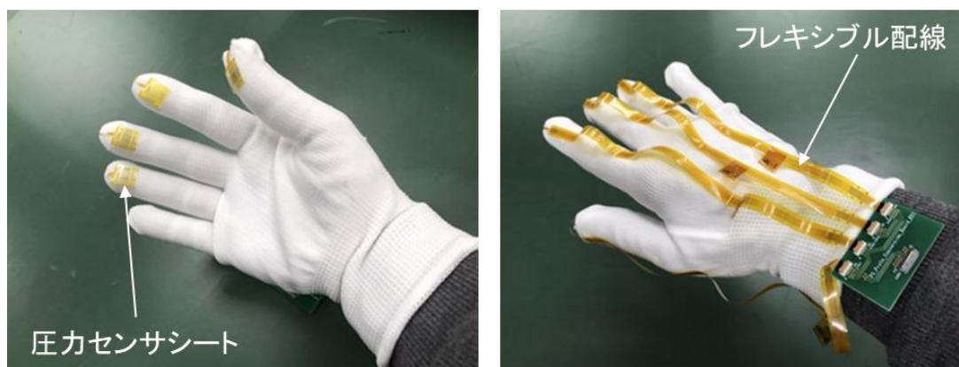
図 3 多点圧力センサのグローブへの簡易装着状態
