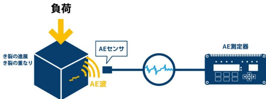
この性質を利用してことで、金型や製品のき裂や摩耗などの不具合を検知することが可能となります。AE 波は装置や金型、材料の摺動などでも発生するため、鍛造の過程(材料変形)で発生する AE 波のみを捉えて評価する必要があります。そのため、AE センサーと金型の位置情報である変位を計測する変位センサー、金型にかかる荷重を計測する荷重センサー(ロードセル)とを組み合わせて評価するシステムを MSM-PF で構成しました。
